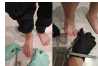
Fot.10 Pomiar szerokości przodostopia z użyciem cyrkla kabłąkowego [źródło: materiały własne]
