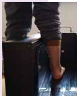
Fot.8 Sposób umieszczenia stopy w skanerze 3D. [źródło: materiały własne]
