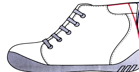
Rys.15 Kształt łuku tylnego pięty w trzewikach (czarna linia – kształt prawidłowy, różowa linia – przywiedzona pięta, fioletowa linia – pięta nadmiernie odwiedzona) [źródło: materiały własne]
