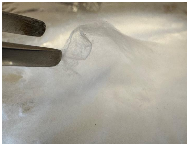
Rys. Elektroprzędzona nanowłoknista mata z octanu celulozy (fotografia własna)
